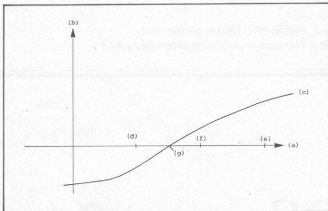
Figura 1 - (a) eixo das abcissas; (b) eixo das ordenadas; (c) gráfico da função; (d) limite extremo esquerdo da iteração; (e) limite extremo direito da iteração; (f) ponto médio entre extremos; (g) raiz da função
